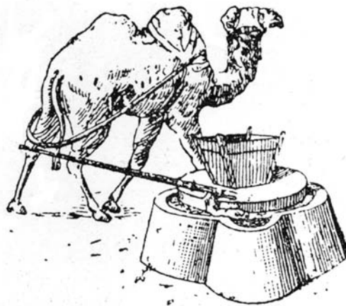
Afb. 8.81 Eenvoudige rosmolen met aandrijving van boven (naar Bennett & Elton 1898, 197).
